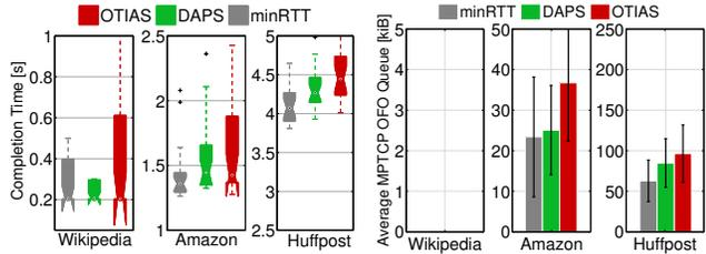
(c) WLAN+WLAN, Completion time (d) WLAN+WLAN, OFO queue
